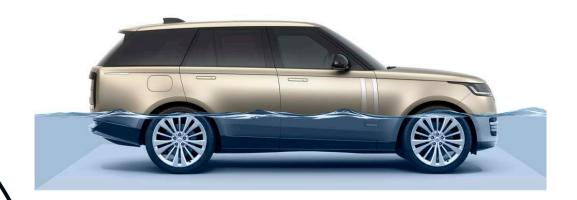
\*Wattiefe (25 Grad Ein- und Ausstieg) 750 mm, erhöhte Wattiefe (9 Grad Ein- und Ausstieg) 900 mm.
