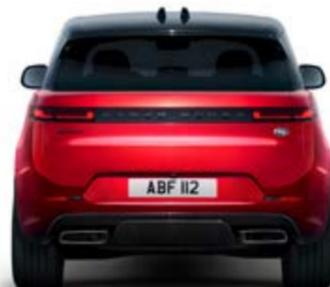
Spurweite hinten 1.704 mm
