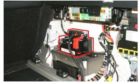
3. Service-/Notfalltrennschalter wie dargestellt entfernen. Befindet sich unter dem abdeckung im Kofferraum.
